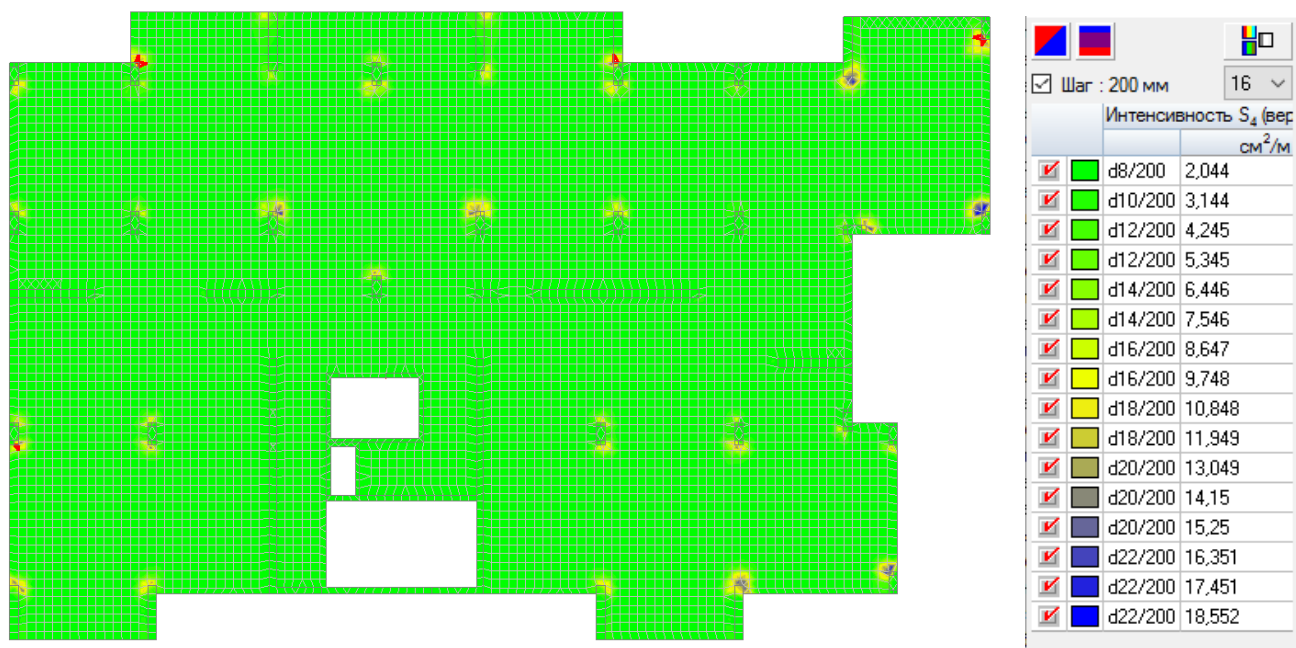
Рисунок 2.3 – Схема верхнего армирования по оси X
