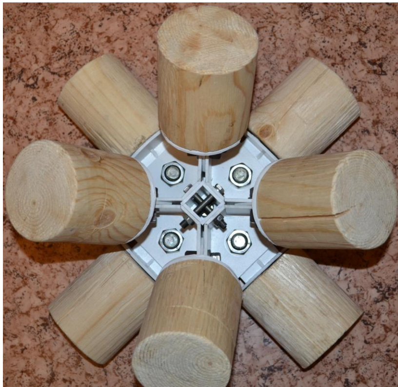
Рисунок 6. Узловое соединение в собранном виде
