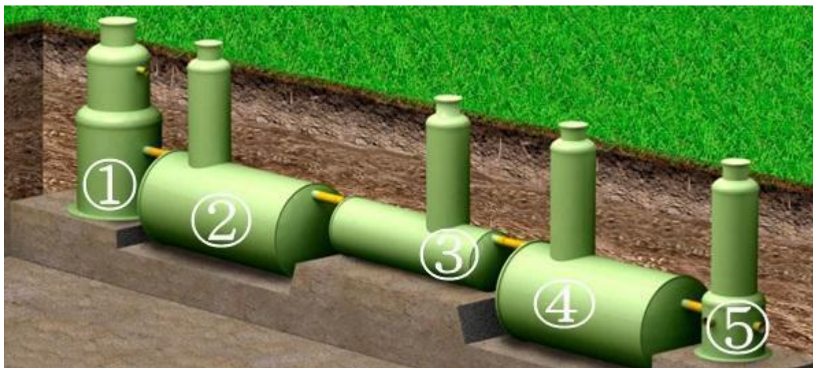
Рисунок 2 – Состав ливневых очистных сооружений
