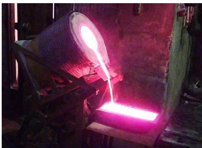
Рисунок 2.3 – Дозирование поворотом индукционной тигельной печью
