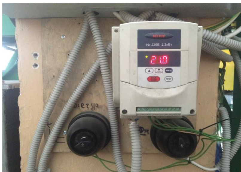
Рисунок 1.15 – Источник питания намотчика (частотный преобразователь Веспер E2 – MINI –S3L)
