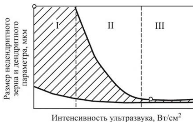
Рисунок 20 – Зависимость размера зерна и дендритного параметра от интенсивности ультразвука
