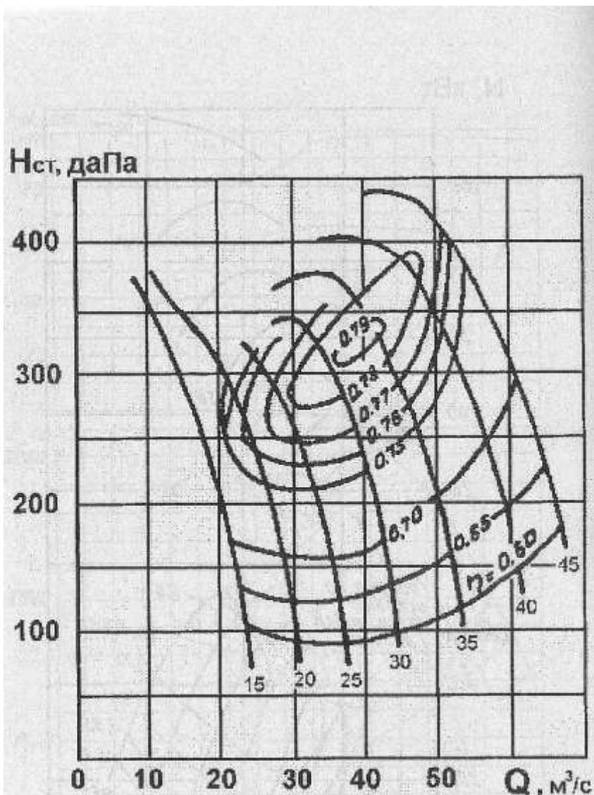
Рис. П110.5. Аэродинамические характеристики вентилятора ВОД-16П при частоте вращения его ротора 985 мин -1
