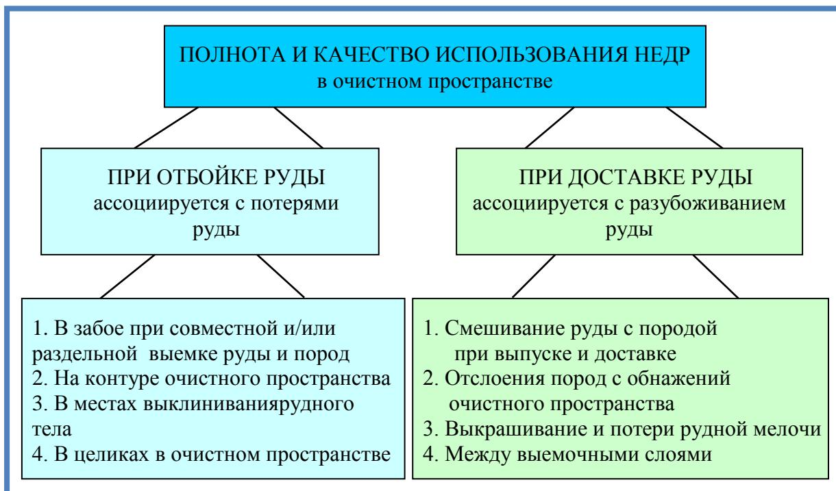
Рисунок 3 - Систематизация полноты и качества использования недр при очистной выемке
