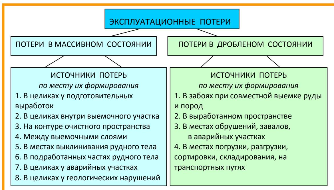
Рисунок 2 - Источники потерь руды при подземной разработке рудных месторождений
