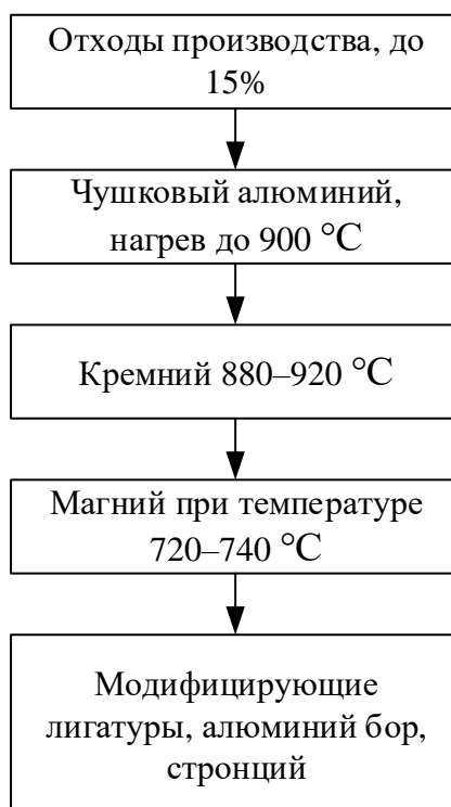
Рисунок 3 – Порядок загрузки шихтовых материалов при плавке при получении сплава
