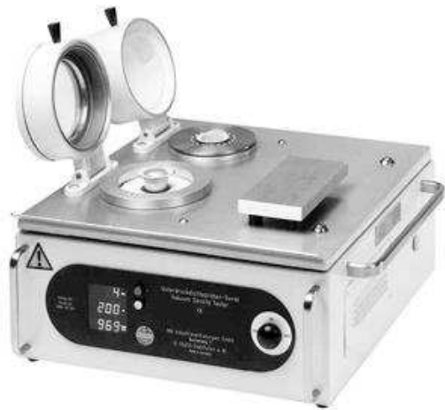
Рисунок 6 – Прибор контроля индекса плотности 3VT
