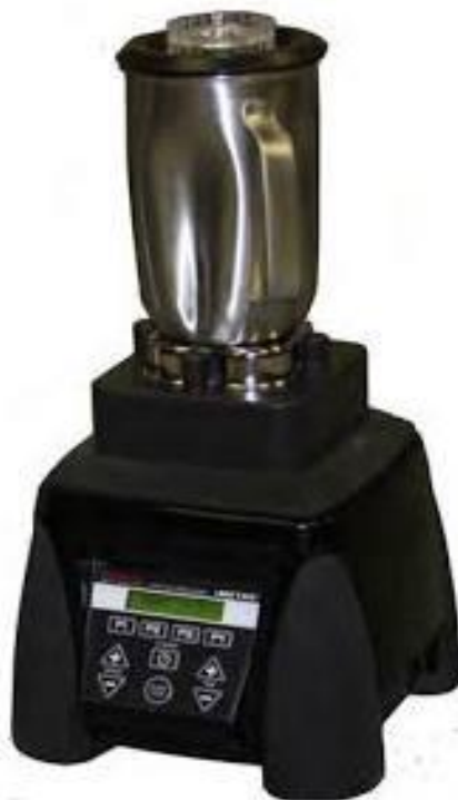
Рисунок 2.10 – Миксер постоянной скорости Chandler Engineering (модель 3260)
