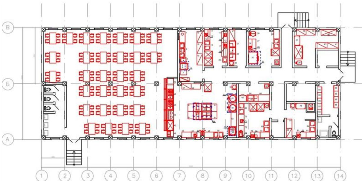
Рисунок А.18 –Модульная столовая на 120 мест на базе 26-ти блок-контейнеров размерами 6х2,45х2,8 ООО «Модуль»
