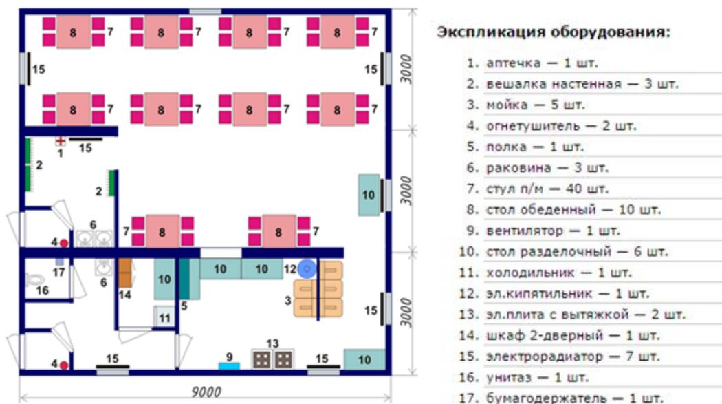
Рисунок А.1 –Модульная столовая на 40 мест на базе 3-х блок-контейнеров размерами 9х3х2,8 ЗАО «ПФК Рыбинсккомплекс»
