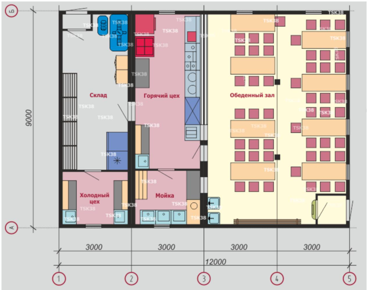
Рисунок А.20 – Модульная столовая на 50 места на базе 4-х блок-контейнеров размерами 9х3х3 ТСК «Подрядчик»
