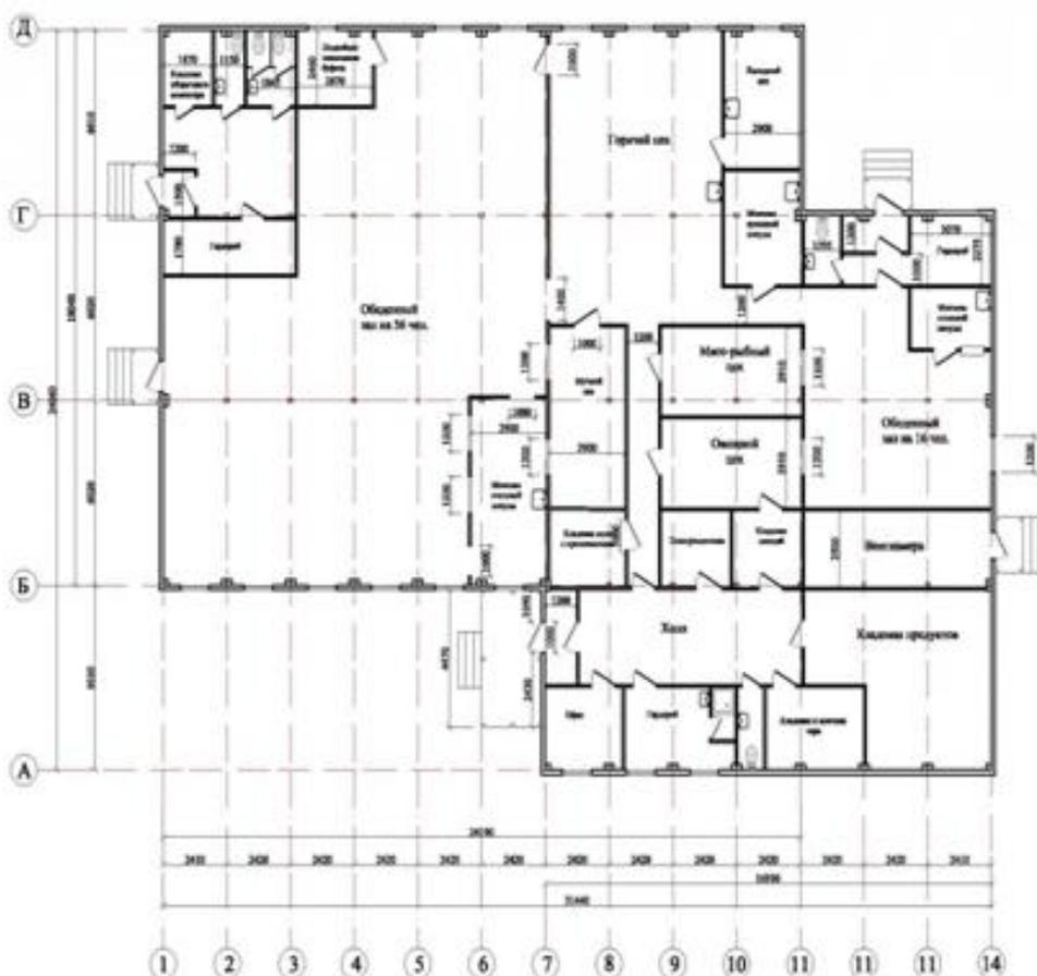
Рисунок А.19 –Модульная столовая на 72 места на базе 43-х блок-контейнеров размерами 6,02х2,45х3 ООО «Модульная конструкция»
