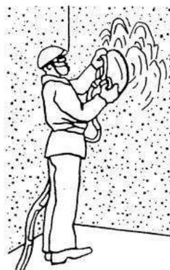
Рисунок 3.7 - Механизированная затирка поверхности
