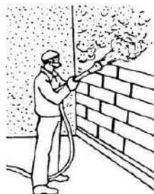
Рисунок 3.5 - Последовательное нанесение слоев обрызга, грунта
