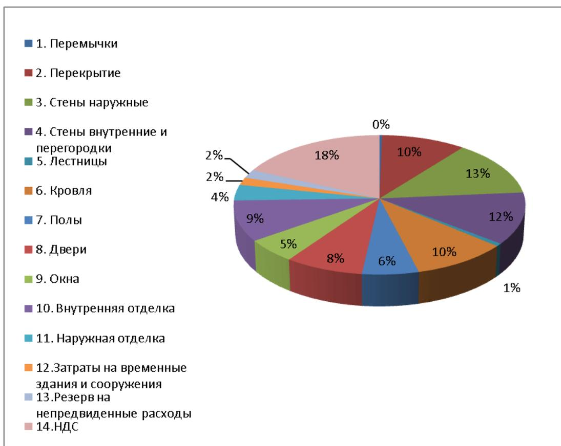
Рис. 5.1 - Структура локального сметного расчета на общестроительные работы надземной части здания по разделам
