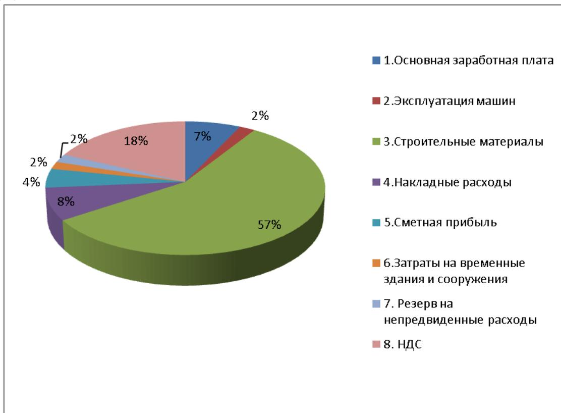
Рис. 5.2 - Технологическая структура локального сметного расчета надземной части.
