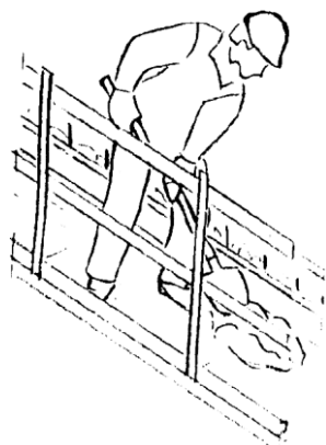
Рисунок 4.10 – Очистка лопатами просыпавшегося бетона
