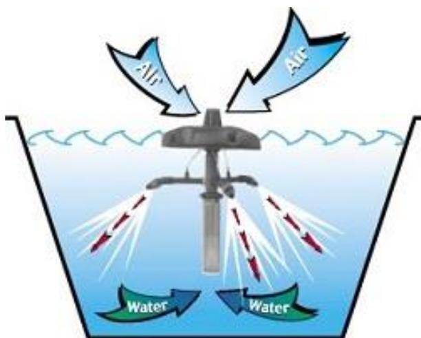
Рисунок 8 – схема воздухообмена, вследствие которого происходит насыщение воды кислородом.
