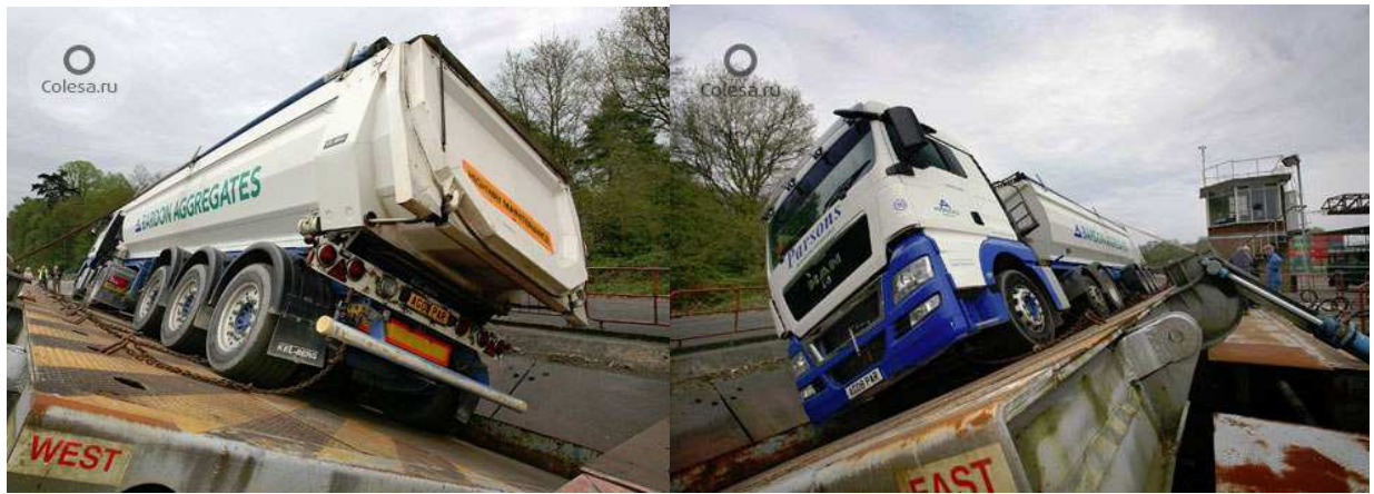
Рисунок 3 – Типовая платформа для опрокидывания (для определения статической поперечной устойчивости транспортных средств)
