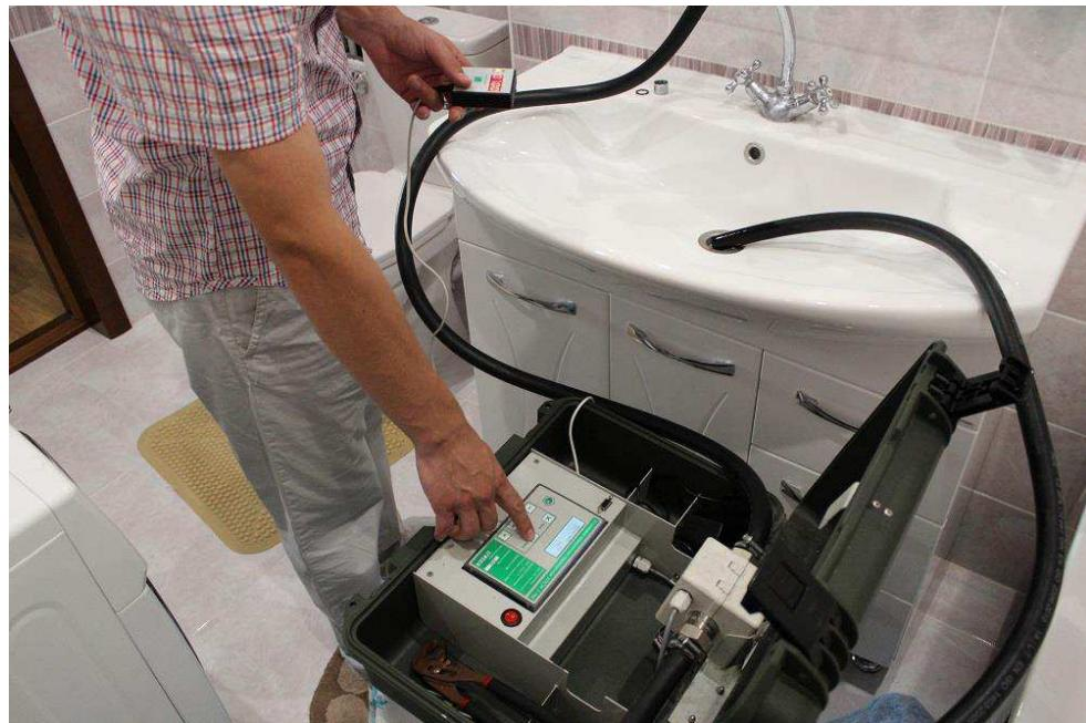
Рисунок 12 – Переносная поверочная установка в процессе работы
