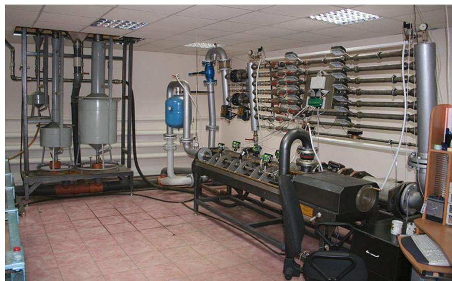
Рисунок 10 – Стационарная поверочная установка
