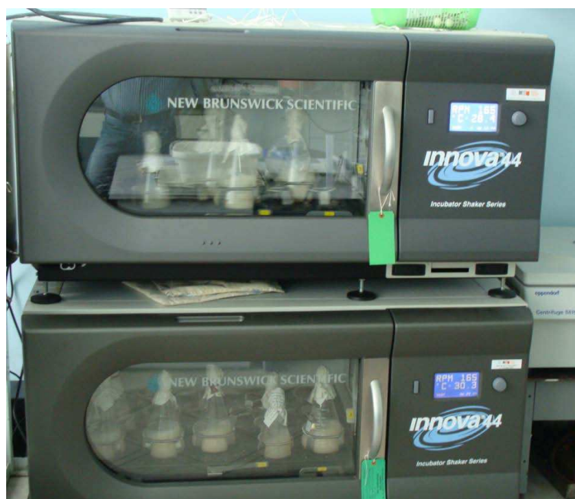
Рисунок 5. Фото шейкеров-инкубаторов «Incubator Shaker Innova®» для культивирования бактерий в колбах объемом от 1 до 3 л.
