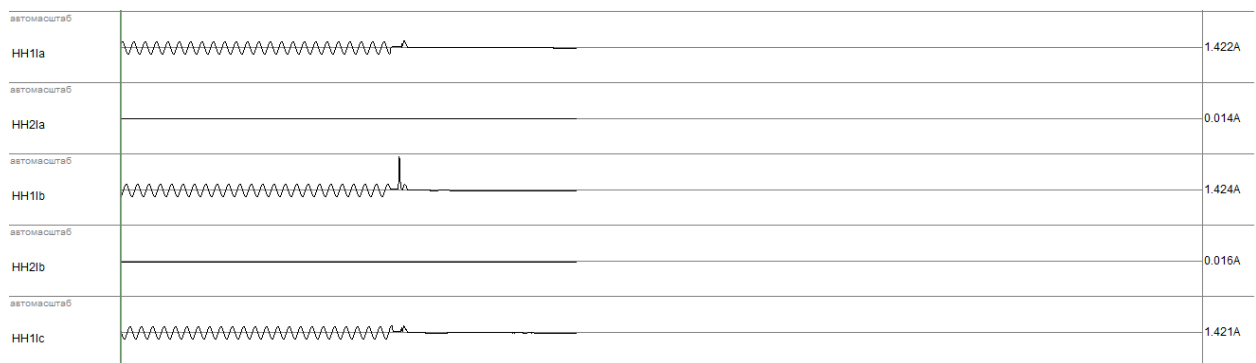
Рисунок 7.9 — Осциллограммы токов при срабатывании МТЗ НН
