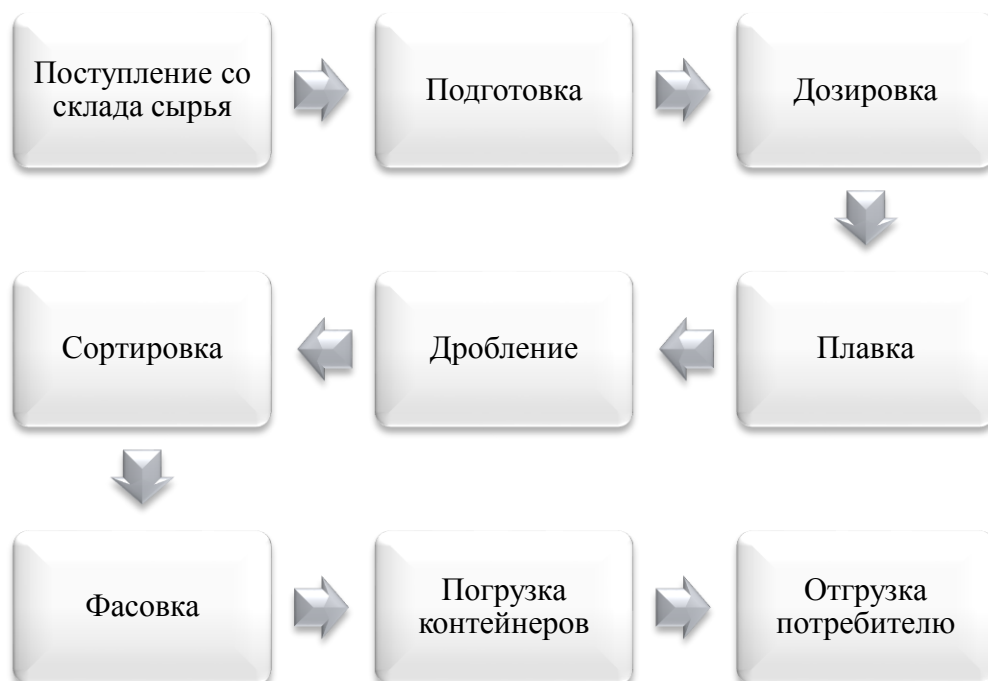
Рисунок 20 – Технология производства ферросилиция
