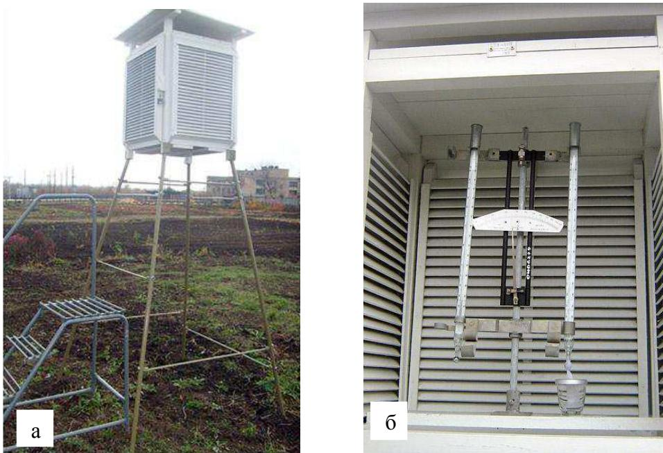
Рисунок 2 –Психрометрическая будка (а) и ее внутреннее устройство (б) [54]
