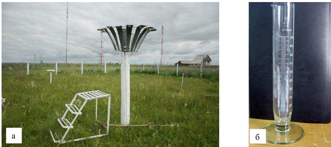
Рисунок 3 – Приборы для измерения осадков: а - осадкометр, б - измерительный дождемерный стакан [54]
