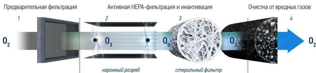
Рисунок 3.5 – Принцип очистки воздуха на основе электрофильтрации
