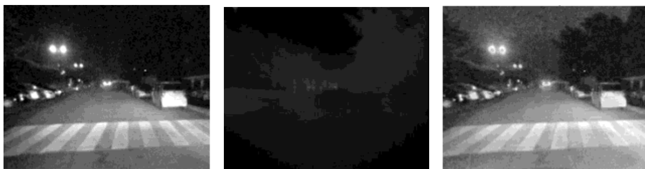
Рисунок 5 — Пример обработки данных, полученных в ночное время: a) — исходное RGB изображение; б) — исходное инфракрасное изображение; в) — изображение, полученное с помощью предлагаемого алгоритма
