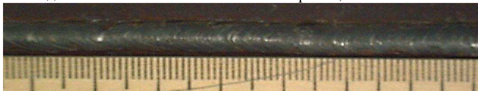
Рис. 1. Внешний вид наплавленного валика: I_d=150\text{ А} , U_d=20\text{ В} , V_{св}=16\text{ м/ч} .
