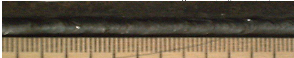
Рис. 2. Внешний вид наплавленного валика: I_d=120\text{ А} , U_d=20\text{ В} , V_{св}=16\text{ м/ч} .
