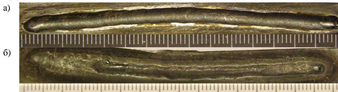
Рис. 3. Валик, наплавленный на малоуглеродистую сталь: а - лицевая сторона, б - обратная сторона
