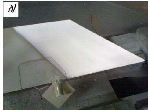
Рис. 5. – Примеры упрочненных деталей с керамическими покрытиями: а – упрочненные подшипники скольжения ванны горячего оцинкования; б – стабилизатор с нанесенным термобарьерным покрытием;
