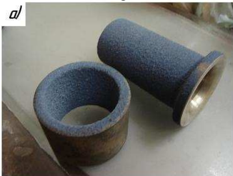
Рис. 5. – Примеры упрочненных деталей с керамическими покрытиями: а – упрочненные подшипники скольжения ванны горячего оцинкования; б – стабилизатор с нанесенным термобарьерным покрытием;
