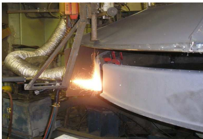
Рис. 1. Нанесение износостойкого покрытия на лопатки ротора нагнетателя
