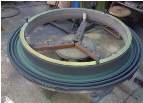
Рис. 4. Упрочненное дистанционное кольцо прокатного вала
