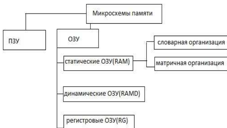
Рис.1 Классификационная схема микросхем памяти
