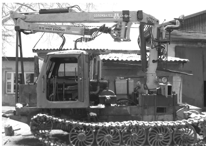
Рисунок 2 – Модернизированная установка гидроманипулятора СФ-65С на трактор ТТ-4М
