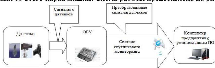
Рисунок 2 – Принципиальная схема работы бортовой системы контроля с установленным программным обеспечением на компьютере предприятия
