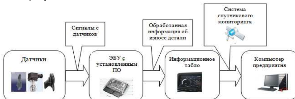
Рисунок 1 – Принципиальная схема работы бортовой системы контроля с установленным программным обеспечением в ЭБУ
