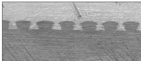
Рис.2. Общий вид сварного соединения типа «ласточкин хвост»
