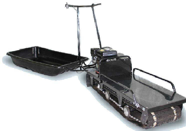
Рисунок 1. Мотобуксировщик в сцепке с санями
