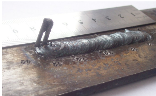
Рис. 6. Остановка процесса при пробое покрытия электродов.
