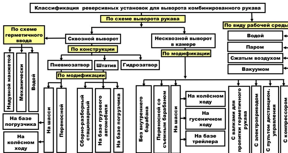
Рис. 4. Классификация реверсивных установок для выворота комбинированного рукава.
