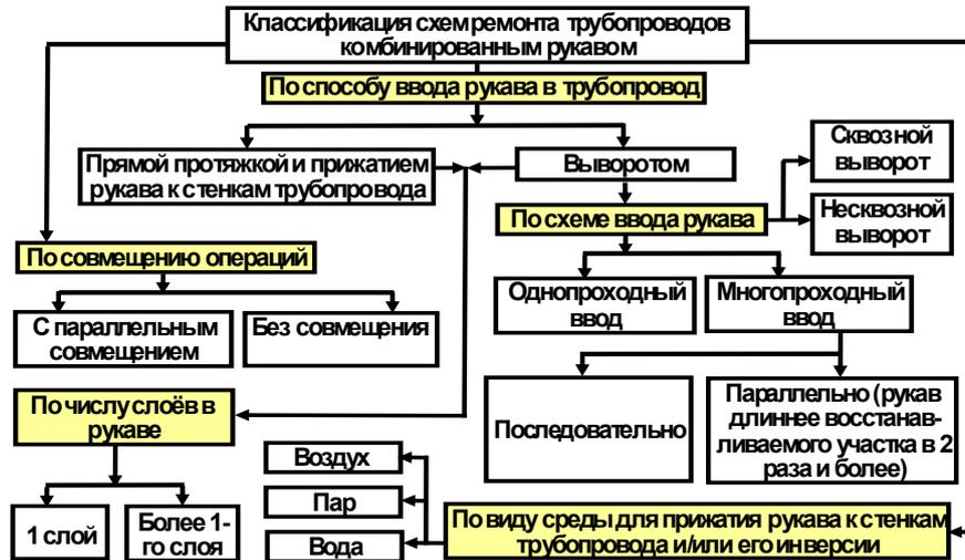
Рис. 3. Классификация схем бестраншейного ремонта трубопроводов способом нанесения композиционного покрытия с использованием комбинированного рукава.
