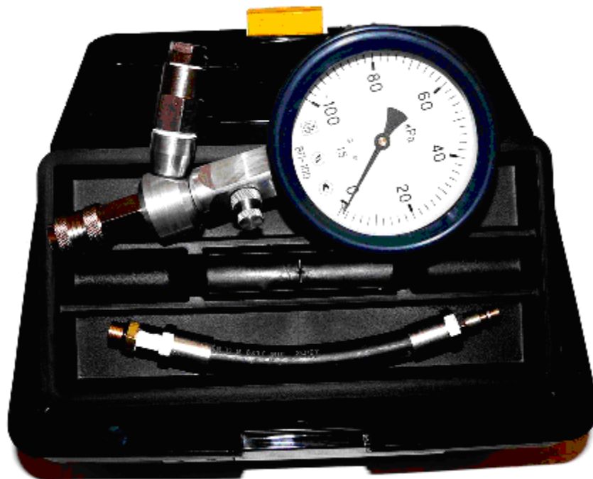
Рисунок 2.2 – Анализатор герметичности цилиндров
