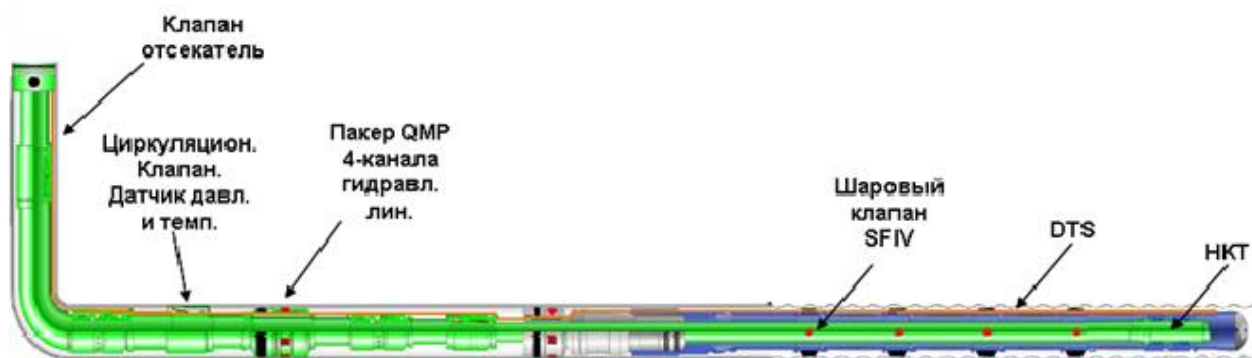
Рисунок 2.3 - Принципиальная схема интеллектуального заканчивания скважины 13
