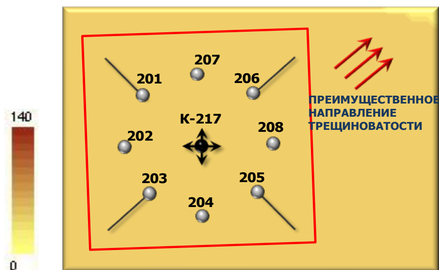
Рисунок 12 - Схема расположения скважин на участке ОПР-2
