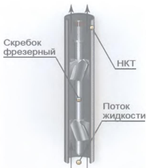
Рисунок 2.1 - Схема метода фрезерования
