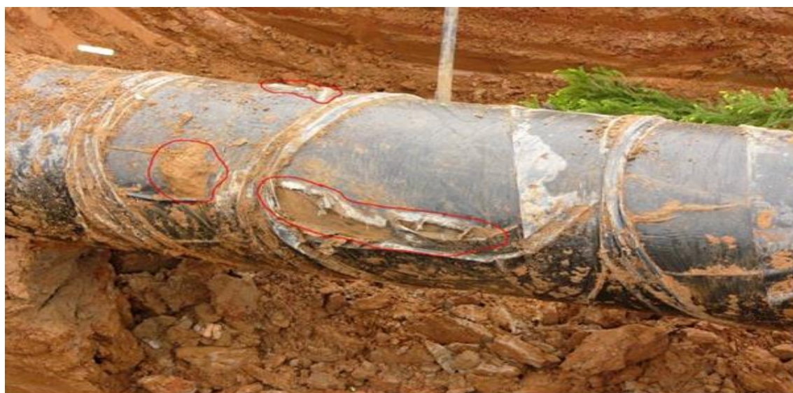
Рисунок 1.6 - Визуально видимая коррозия секции № 2260.
