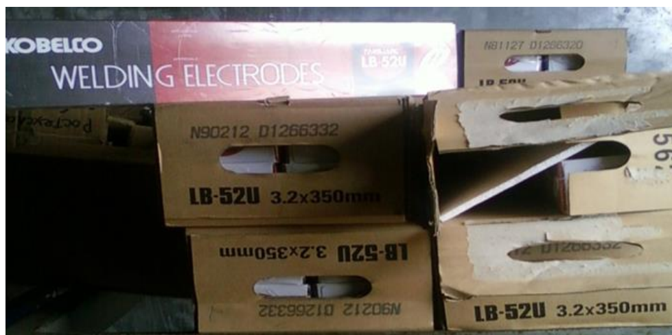
Рисунок 3.7 - Электроды для прихватки муфты
