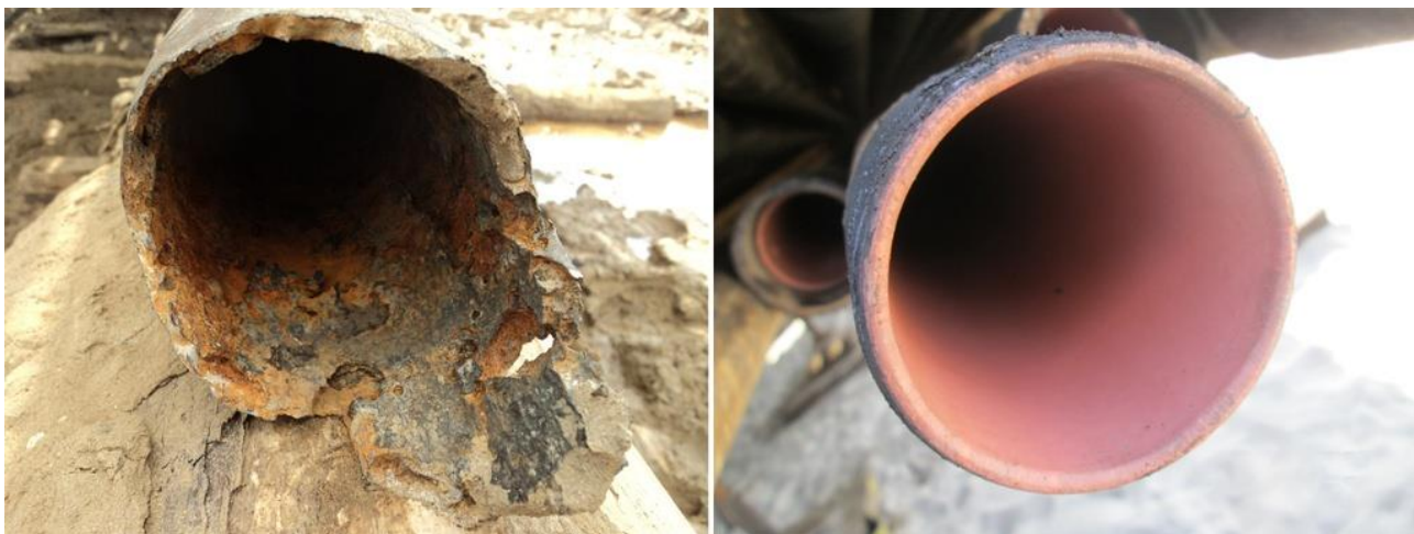
Рисунок 7 – НКТ без полимерного покрытия (слева) и с полимерным покрытием (справа)
