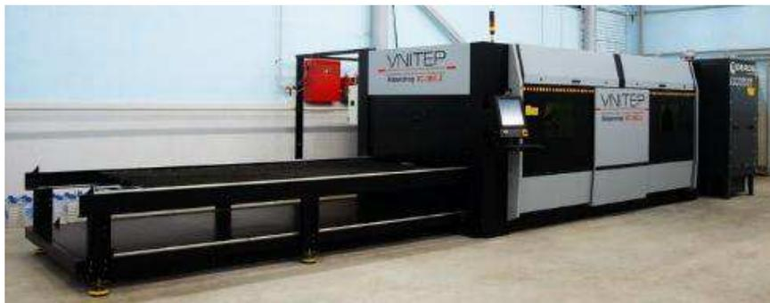
Рисунок 3.2 – раскроечный центр VNITEP Навигатор КС-3ВС-2
