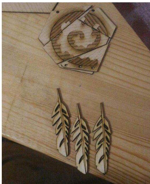
Рисунок 3.7 – Шпон ясеня и фанера, обработанные на лазерном станке
