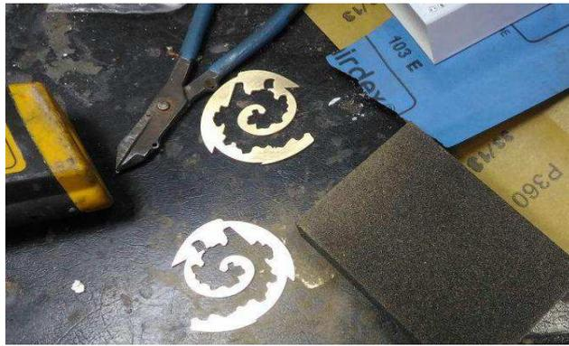
Рисунок 3.4 – Шлифовка детали
