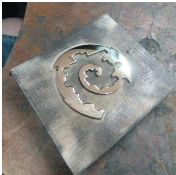
Рисунок 3.6 – Полировка латунной детали
