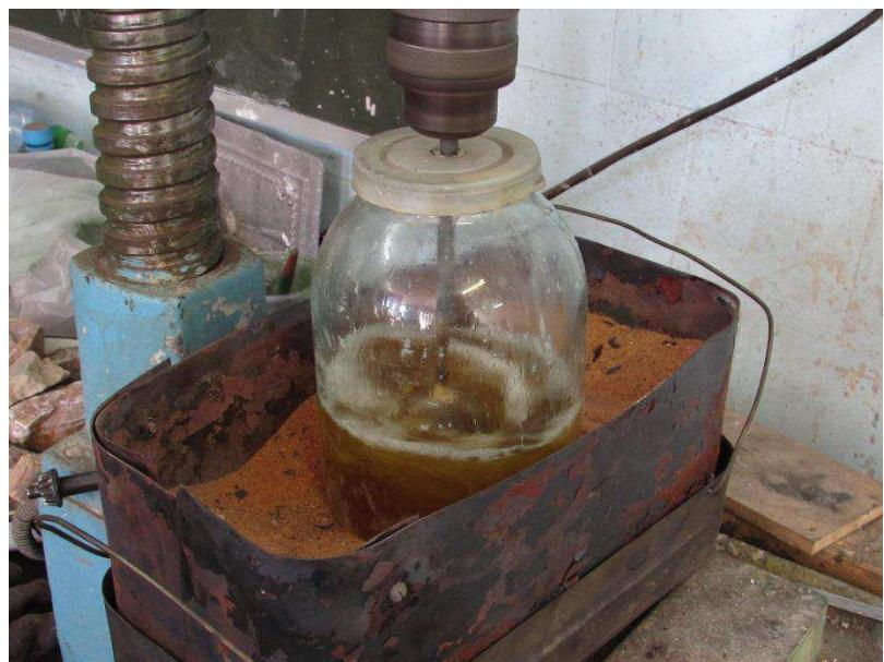
Рисунок 29 – приготовление связующего для суспензии
