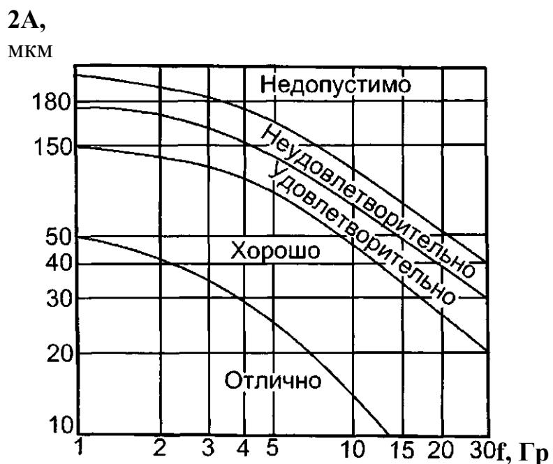
Рисунок 4.1- Характеристики для определения состояния гидроагрегата по вибрациям опорных частей
