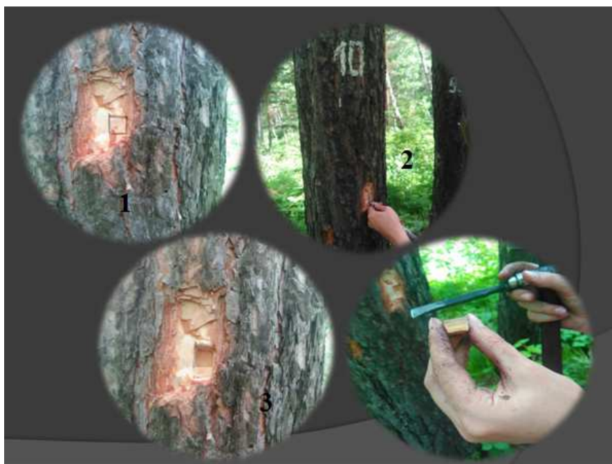
Рисунок 17 - Схема взятия проб древесины методом высечек
