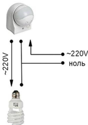
Рисунок 4.34 - Схема подключения датчика движения
