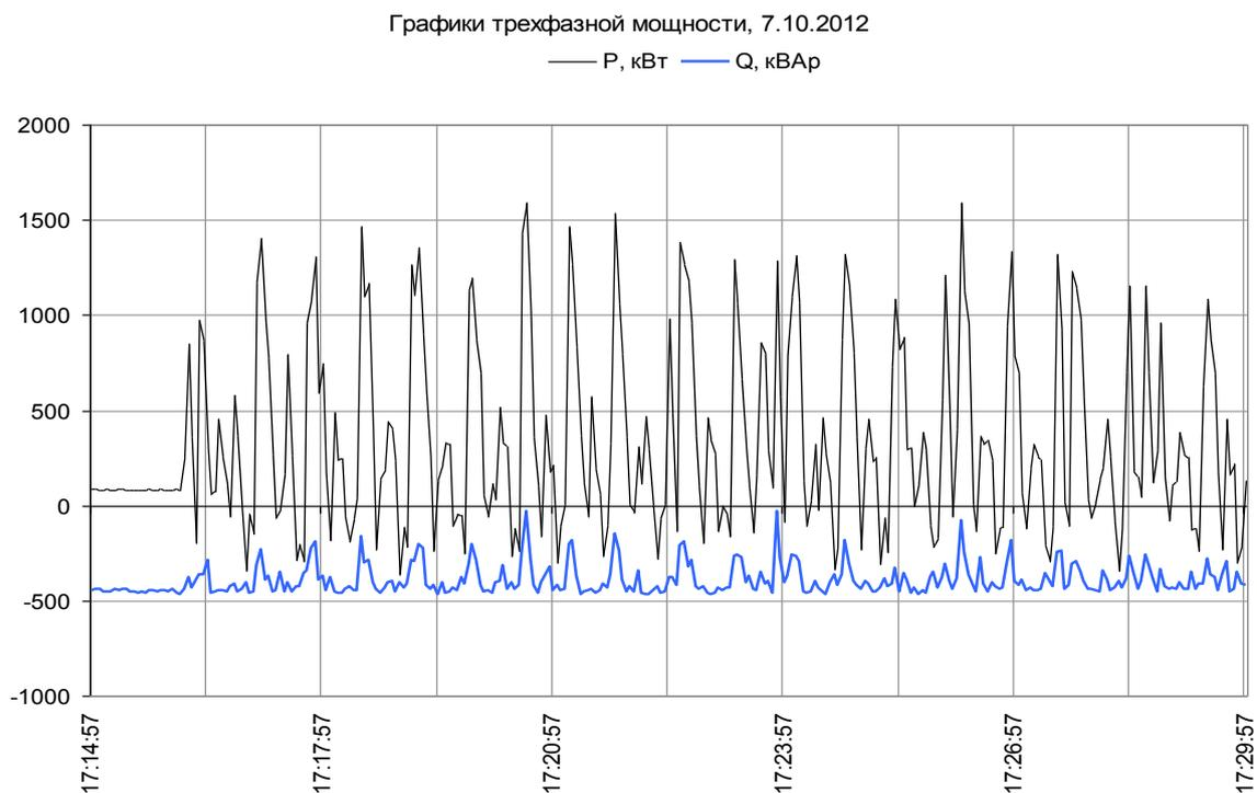
Рисунок 4.37 - Графики активной и реактивной мощности экскаватора ЭКГ-15 №15
