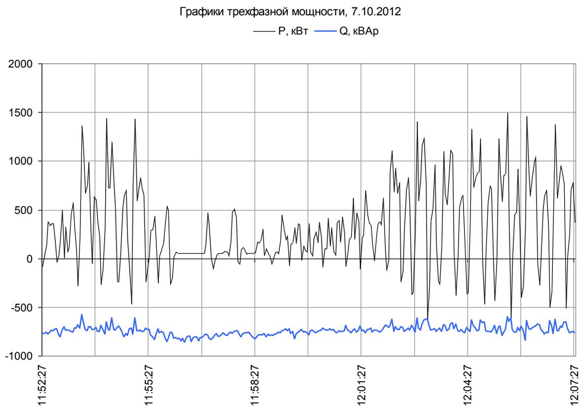
Рисунок 4.38 - Графики активной и реактивной мощности экскаватора ЭШ 11/70 №44
