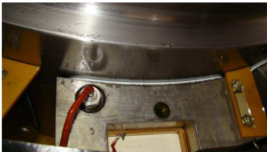
Рисунок 9.2- датчик СТК в сегменте подшипника.
