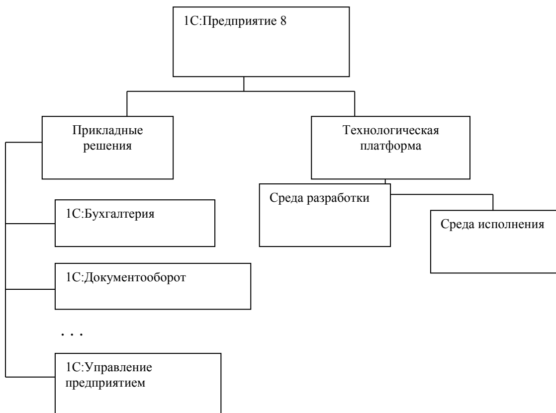
Рисунок 6 – Схематическое устройство системы «1С:Предприятие 8»
