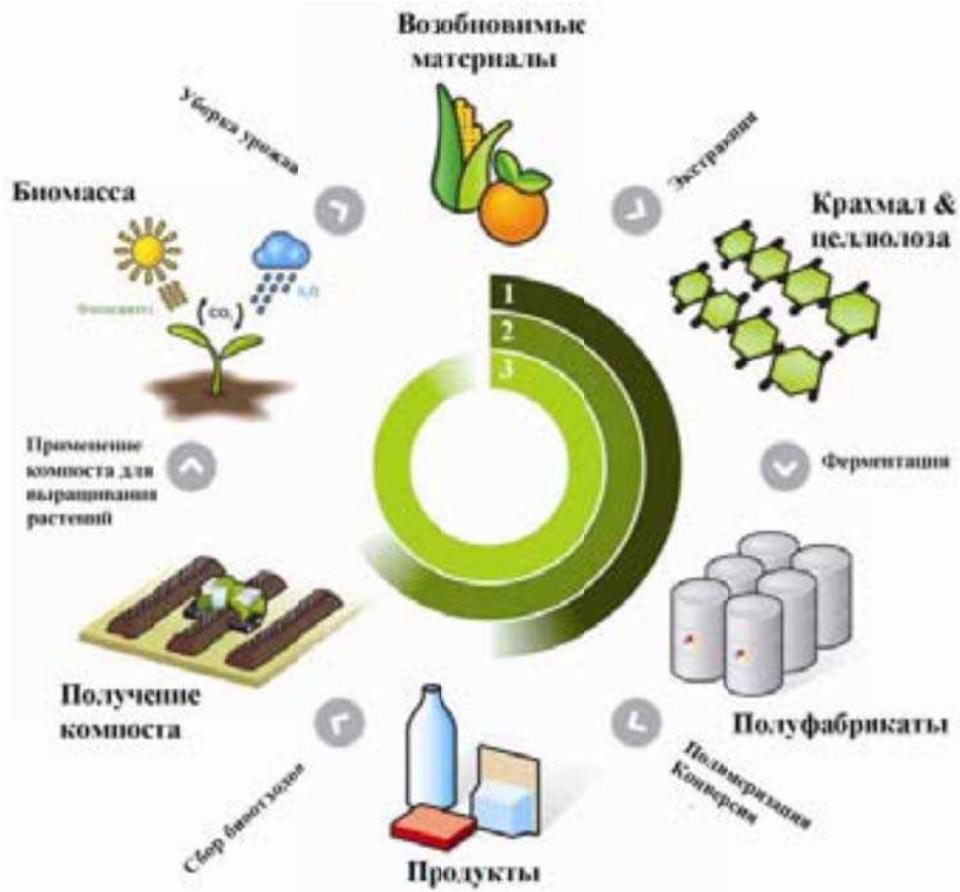
Рисунок 1 – Схема производства, потребления и утилизации полимеров, полученных из возобновляемых источников, включающая стадию компостирования: 1 – путь от сбора урожая до получения продукта; 2 – путь от сбора урожая до утилизации биополимеров; 3 – путь от сбора урожая до сбора урожая [47]
