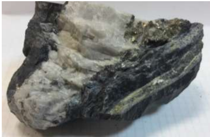
Рисунок 11 – Жила молочно-белого кварца в серицитовом сланце. По зальбандам гнёзда пирита. Серицит по трещинам поперечным сланцеватости
