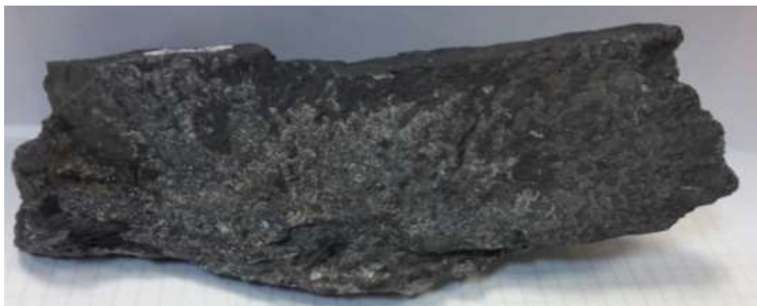
Рисунок 4 – Хлорит-серицитовый сланец со сфалеритом, пирит-пирротинном по поперечным трещинам сланцеватости
