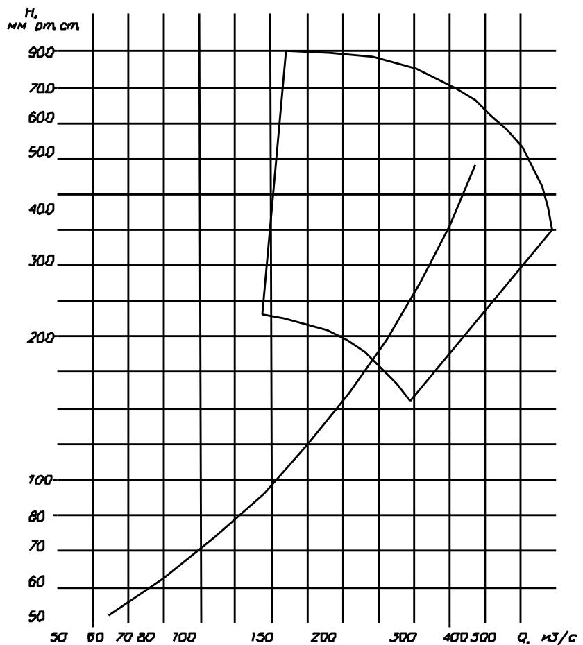
*Рис.5.1. Совмещённый график работы вентилятора и вентиляционной сети*
