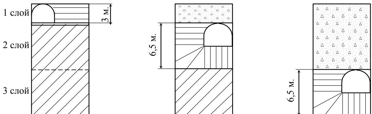
Рис. 10. Схема развития очистных работ в секции слоями сверху вниз.
