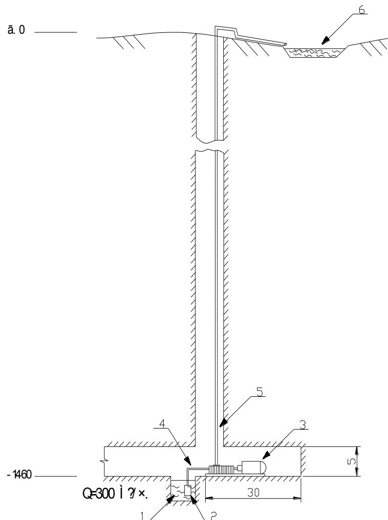
Рисунок 1- Схема водоотлива
