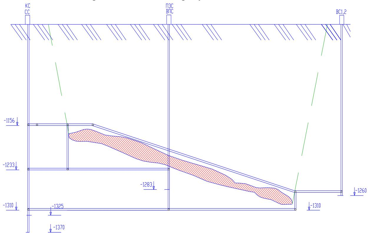
Рис.2.8. Вскрытие месторождения вертикальным скиповым стволом в лежачем боку месторождения посередине линии простираия, вне мульды сдвижения горных пород.
