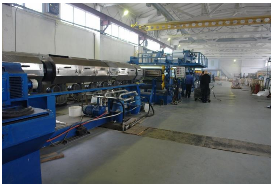
Рисунок 1.9 - Линия по производству алюминиевых композитных панелей
