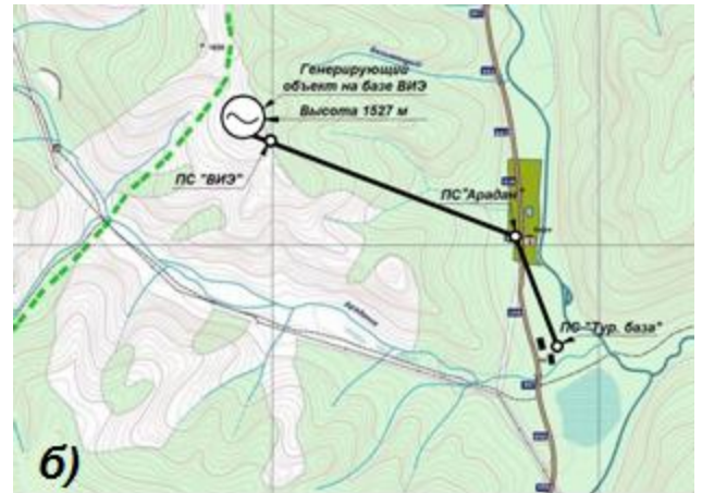
Рисунок 5.3 – Варианты электроснабжения пос. Арадан и тур. базы ООО «Дороги сибери»: а) от ЛЭП 220 кВ; б) от генерирующего объекта на базе ВИЭ
