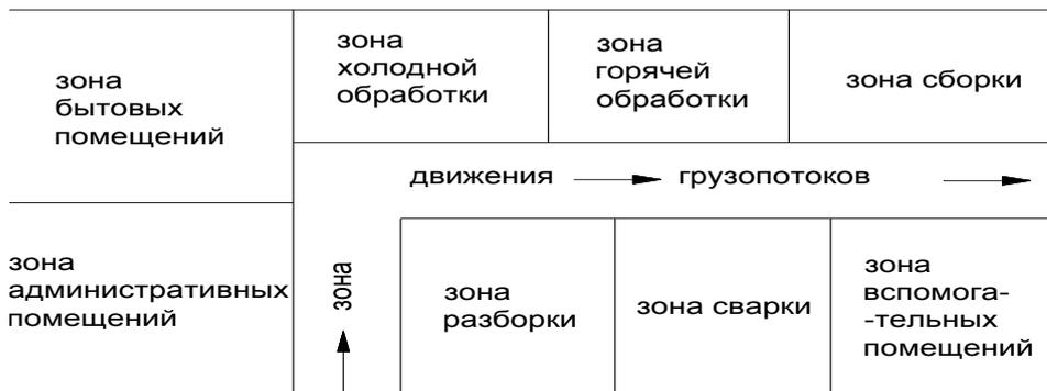
**Рисунок 5.1 - Технологическая схема ремонтной базы предприятия с криволинейной зоной движения грузопотоков.**
