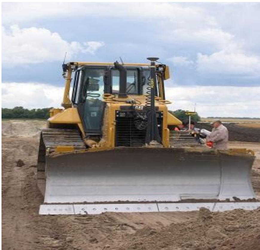
Рисунок 7.6 Система PowerGrade с одним датчиком поперечного наклона.
